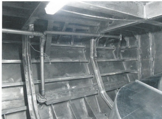
Particolare dello scafo interno in alluminio durante la costruzione
